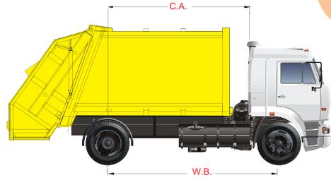
**مقدمة :** مكابس النفايات ذات التحميل الخلفي يتم إفراغ الحاويات فيها وضغطها داخل جسم المكبس وفق عمليات متتابعة ومتوافقة مع الغراف والإجكتور ، ويتم تفريغ النفايات من الحاوية عن طريق أوناش أو ميكانيزمات ، أما كبس النفايات فيكون وفق تحكم هيدروليكي متطور ، لذلك فإن مكابس النفايات ذات التحميل الخلفي سريعة وإقتصادية كما تضمن أمان فائق للعامل عند التشغيل، مزودة بلمبة تحذيرية للسلامة ، فهي تقدم طريقة عصرية ومبتكرة للحفاظ على بيئة نظيفة
